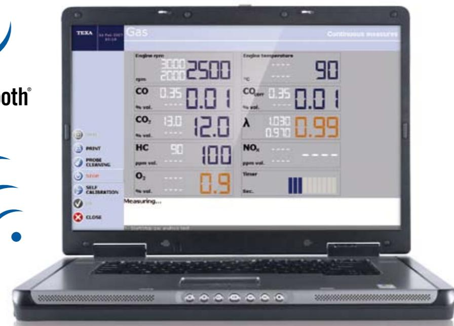
Bežična Bluetooth veza omogućuje da GASBOX Autopower i RC3, interface mjerena broja okretaja, komuniciraju sa jedinicom prikazivanja (PC, MULTI PEGASO stanica, AXONE Palm ili Pad) bez ožičenja.
