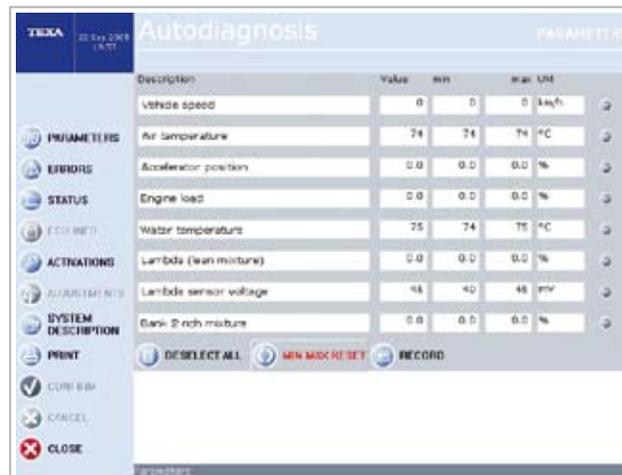
Na primjer, možete provjeriti listu parametara sistema odabirom dijagnostičkog programa i spajanjem na kontrolnu jedinicu. Podaci mogu biti prikazani i grafički.
